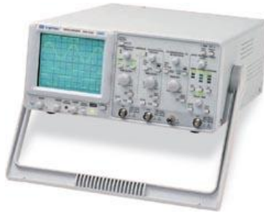
Şekil 1.6: Çift kanallı osiloskop örneği
